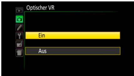
Abb. 3.6: Aktivierung des Bildstabilisators bei VR-Objektiven ohne VR-Schalter
