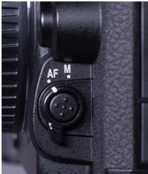
Abb. 3.5: Fokusschalter der D7500. Bei Verwendung moderner AF-S- oder AF-P-Objektive kann dieser immer in AF-Stellung vorbeiben und Sie können das Objektiv selbst auf manuellen Betrieb umschalten, wenn gewünscht. Nur bei alten AF-Objektiven mit mechanischer Kopplung müssen Sie hier auf »M« umschalten, um manuell fokussieren zu können.
